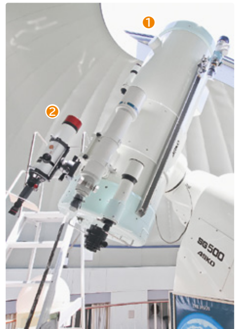
▲県内有数の大きさを誇る50cm反射望遠鏡(①)と直接太陽を見ることが出来る10cmH \alpha 太陽観望専用望遠鏡(②)
