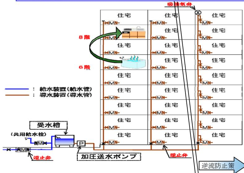
【図5.4-7】 集合住宅における想定逆流模式図（給水立管頂部はP止め又はGV止め）
