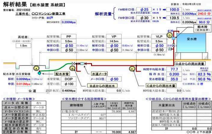
図6-20 減圧弁設定水圧 0.200MPa(その1)
