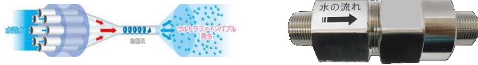
旋回流の仕組み概要図 ウltraファインバブル発生器具 (例) (メーカーHP より)
