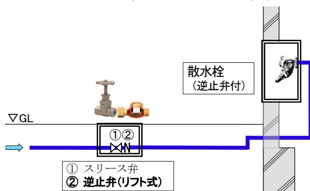
【図 5.7-5】 壁面設置の散水栓の配管要領図
