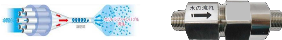
【図 5.6-3】 旋回流の仕組み概要図 ウルトラファインバブル発生器具（例） (メーカーHPより)
