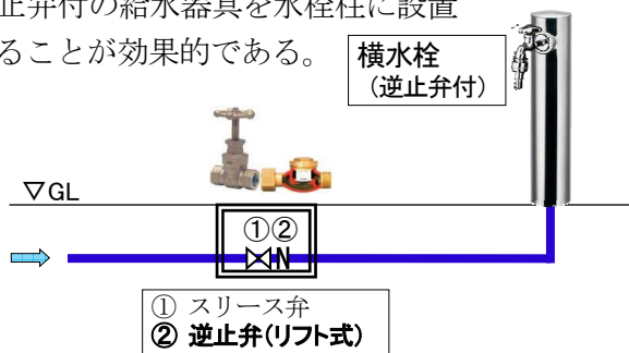
【図 5.7-6】 地上設置の横水栓（水栓柱）の配管要領図
