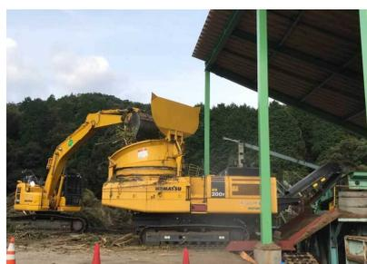
②回収した木材廃棄物を破砕機によりチップ化
