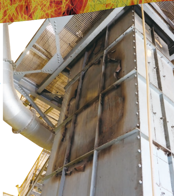
R6.12月に起きた火災によって焦げた 晴丘センターの第2排出コンベア
