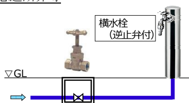
【図 5.5-15】 水栓柱に設置の給水栓 (例)
