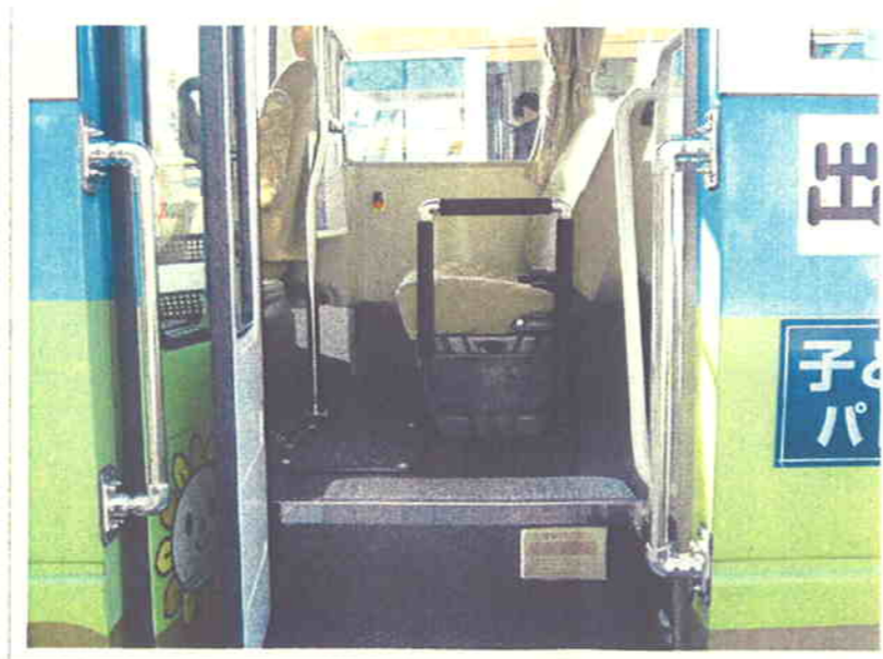
手摺り設置状況
