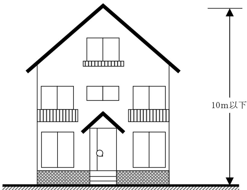
※ 階段室、昇降機塔など建築物の屋上部分の水平投影面積の合計（A）が建築物の建築面積（B）の8分の1以内であれば、その部分の高さ（H）が5メートルまでは、建築物の高さに算入しません。
